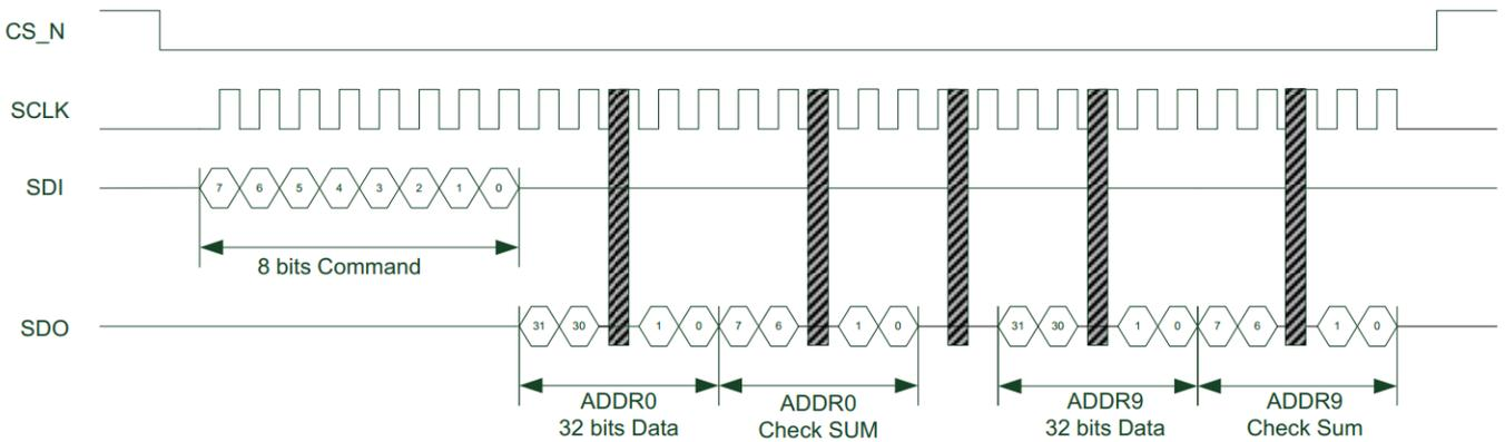
Figure 4-8 SPI 连续寄存器读命令帧时序 (包含和校验)
