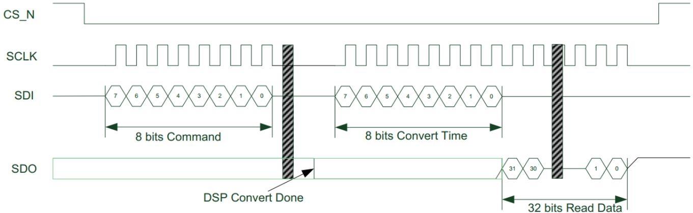
Figure 4-9 SPI 单次转换命令帧时序 (不包含和校验)
